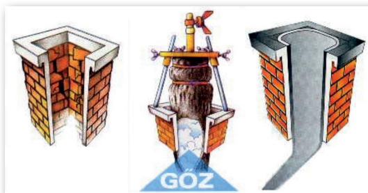
38. ábra: A FuranFlex® műanyag kéménybélés- cső beépítésének lépései
